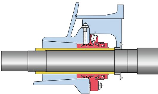
Garniture mécanique renforcée «Heavy duty».
