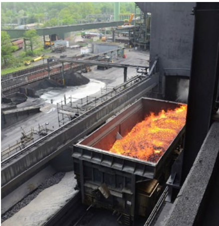
Der glühende Koks im Löschwagen beim Einfahren unter den Löschurm (Wikipedia)
