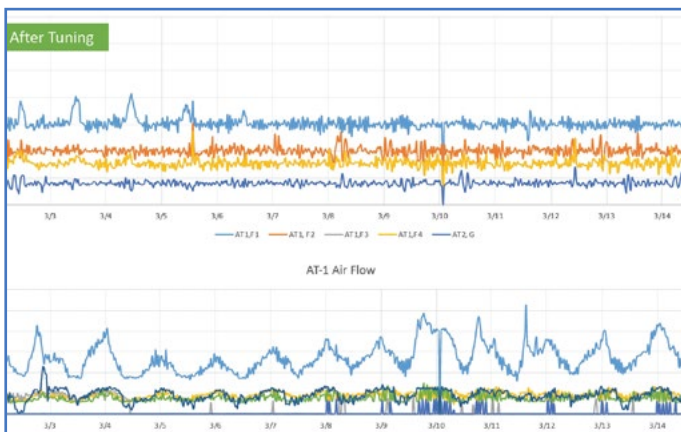
Fig. 6 : Valeurs réelles de l'oxygène à la station d'épuration d'Upper Blackstone avec des vannes de régulation à diaphragme Iris® et une régulation optimisée de la pression variable
