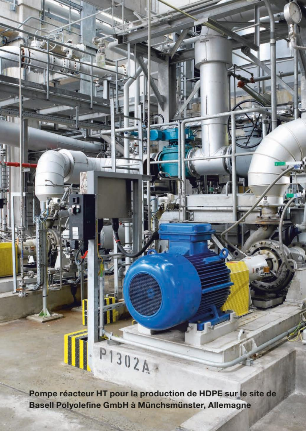
**Pompe réacteur HT pour la production de HDPE sur le site de Basell Polyolefine GmbH à Münchsmünster, Allemagne**
