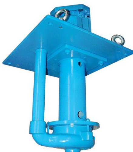
Installation typique de pompes hybrides en construction cantilever sans étanchéité. Idéale pour un fonctionnement en barbotage en puits et bacs; insensible au fonctionnement à sec.
