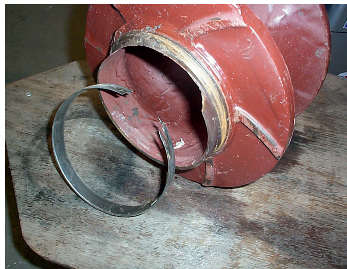
Bild 2: Verschlissene Spaltringe durch Unwucht in Kanalradpumpe
