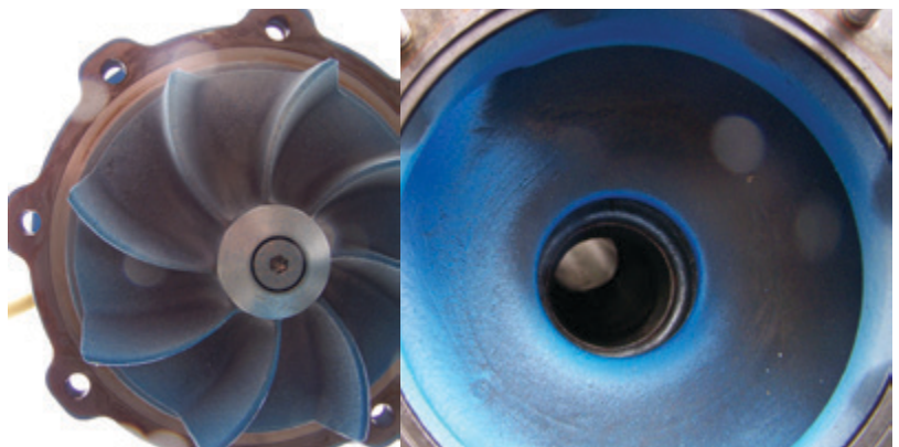
Bild 1: Pumpe in Chrom-Molybdän-Hartguss, Start des Langzeitversuchs 06/2007
